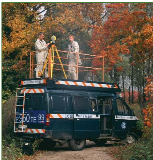
Рис. 2 Геодезическая съемка недоступных территорий
