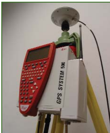
Рис. 5 Двухчастотный спутниковый приемник SR530
