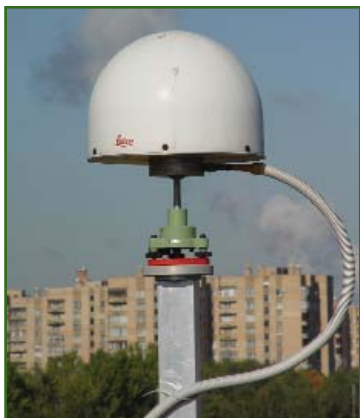
Рис. 2 Спутниковая приемная антенна AT504
