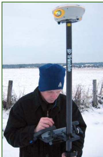
Рис. 2 GPS-съемка в режиме RTK
